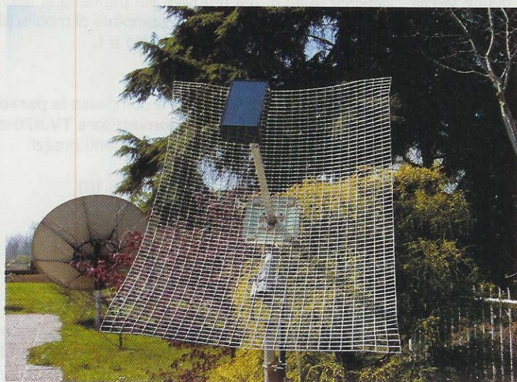
Fig.16 Sul pannello di schermo (vedi fig.14) fissato sulla parabola in senso verticale, dovrete applicare il mobile completo di coperchio plastico per evitare che l'acqua entri nel convertitore TV.970.
