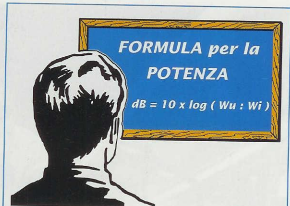
Fig.2 Per calcolare i dB in Potenza occorre conoscere il rapporto esistente tra i Watt prelevati dall'uscita ( W_u ) e quelli applicati sull'ingresso ( W_i ). Chi non ha una calcolatrice scientifica, troverà a fine articolo una Tabella dei dB completa.
