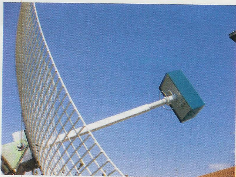
Fig.1 L'illuminatore a spirale va posto sul punto focale di una qualsiasi parabola di tipo circolare oppure di una parabola a griglia, come quella usata per ricevere il Meteosat (vedi rivista N.166).
