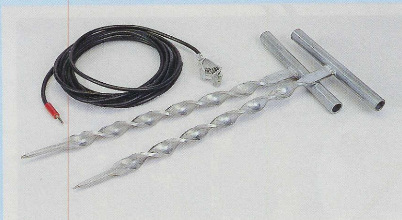
Fig.14 Le due aste di fig.13 andranno conficcate nel terreno ad una distanza di circa 10 metri e collegate ai morsetti A-B con due lunghi fili di rame. Il morsetto T andrà collegato alla presa Terra (foro centrale) della presa di corrente 220-230 volt più vicina.
