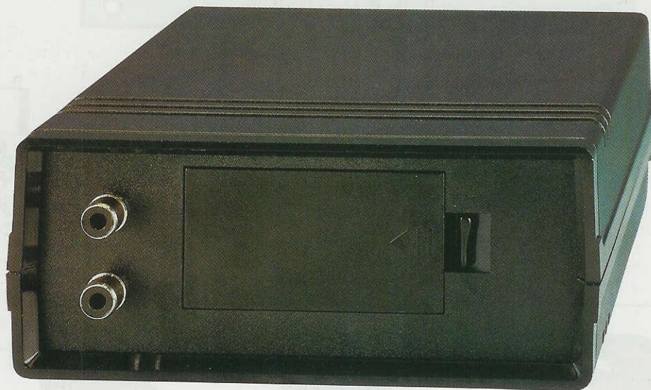
Fig.10 Sul pannello posteriore del mobile, che è di plastica, dovrete fare due fori con una punta da trapano per fissare le due prese di uscita A e B. Sul retro di questo pannello è presente uno sportello che, una volta aperto, mostrerà il vano utile per inserire la pila di alimentazione da 9 volt. Questo vano è visibile anche nella fig.9.
